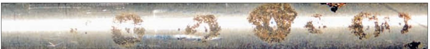
*Abb. 1: Korrosion Längsnaht, geschliffenes Getränkeleitungsrohr*
