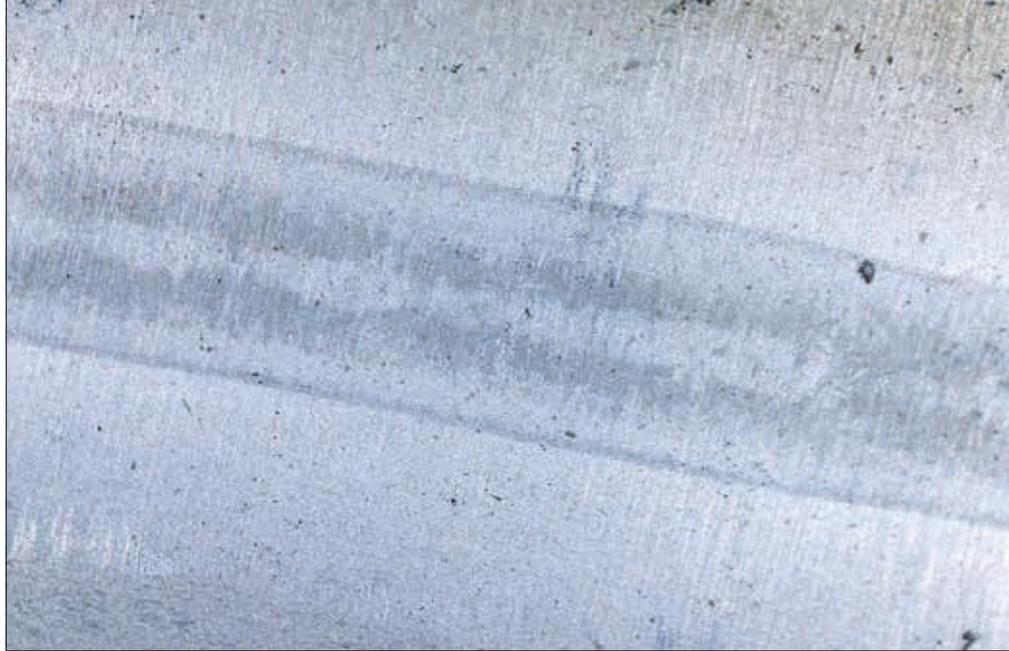
Abb. 3: Längsnaht wirkt optisch fehlerfrei, ist aber viel zu breit und der Schweißzusatzwerkstoff ist nicht sachgerecht.
