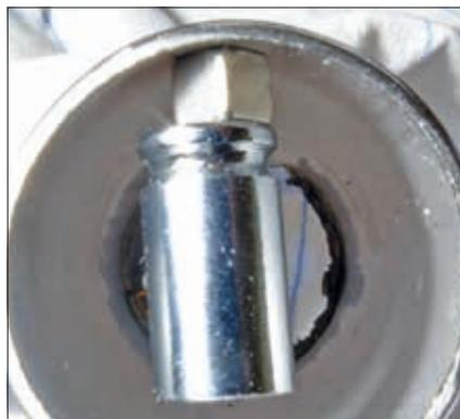
*Abb. 2: Eine magnetisierbare Längsnaht entspricht nicht den allgemein anerkannten Regeln der Technik bei austenitischem Edelstahl rostfrei.*
