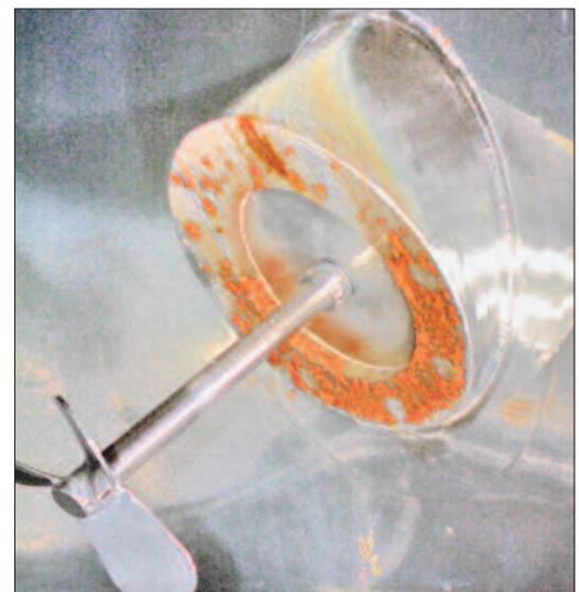
Auf einzelnes Bauteil begrenzte Korrosion
