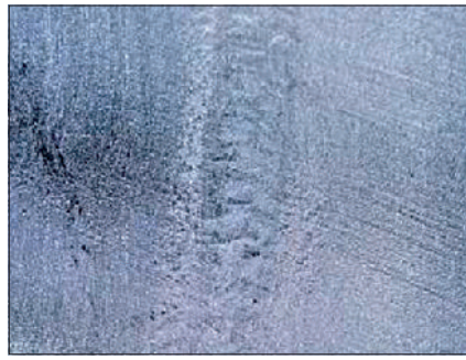
Abb. 5: Ausführung BC, Schuppenstruktur durch Schweißnahtglättung
