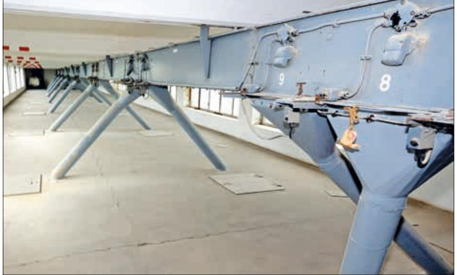
Abb. 2: Trogkettenförderer zur Befüllung von Betonsilozellen
