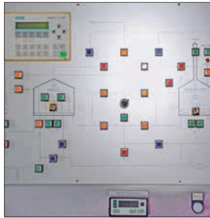
Abb. 4: Siemens C7-621 Komplettgerät in Kombination mit Fließbild
