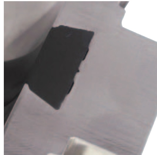
Der größte Bereich der Scheibenventildichtung kann sich in seinem Einbauraum ausdehnen.
