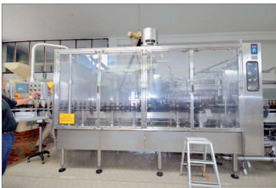
Auch „mechanische“ Füller werden über SPS und mit Software-Reglern gesteuert.
