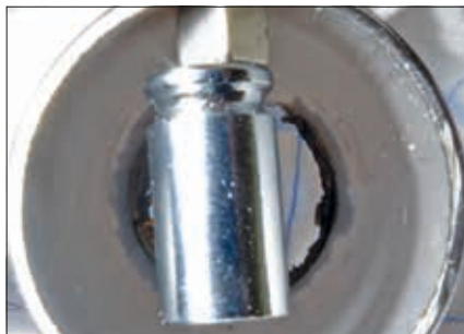
Magnetisierbare Längsnaht eines Rohres: Dies entspricht nicht den allgemein anerkannten Regeln der Technik bei austenitischem Edelstahl rostfrei.
