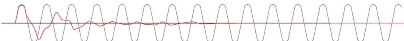
Abb. 1: PID-Regler (grau) und PI-Regler mit dynamischem Soll-Wertgeber (rot) im Vergleich. (Quellen: Kalinowski)
