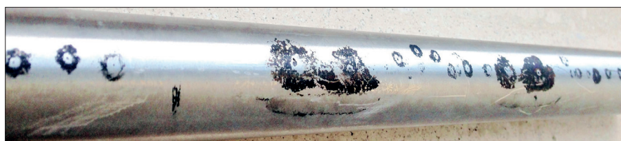
Abb. 4: Lochkorrosion im Bereich einer Rohrlängsnaht
