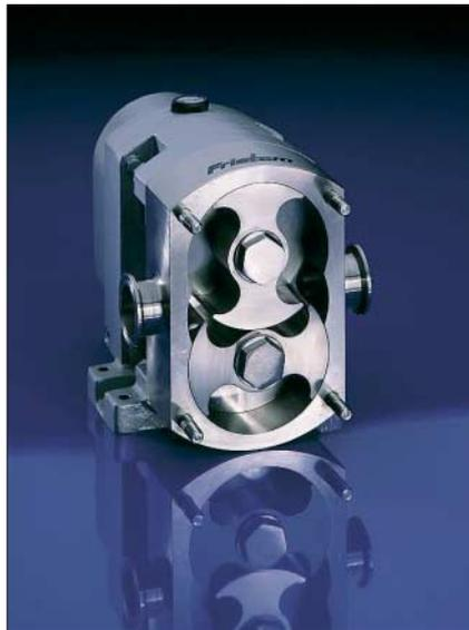
Abb. 6: Drehkolben- oder Kreiskolbenpumpen fördern sehr produktschonend, sie können trockenselbstansaugend ausgeführt sein.
